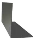
Крепежный профиль Г-образный КПГ-60x44x3000, t=0.9 и 1.2 мм
